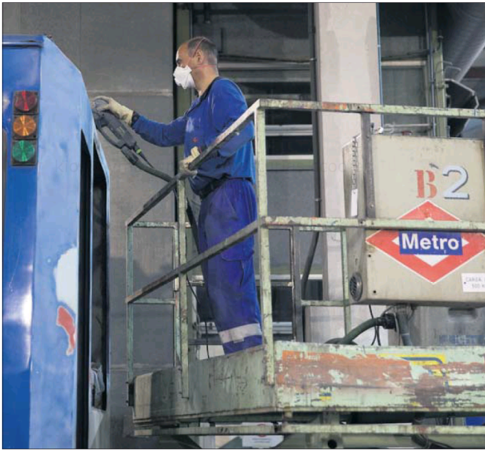
Un operario retira amianto de un vagón de Metro de Madrid, en Canillejas. / VÍCTOR SAINZ
